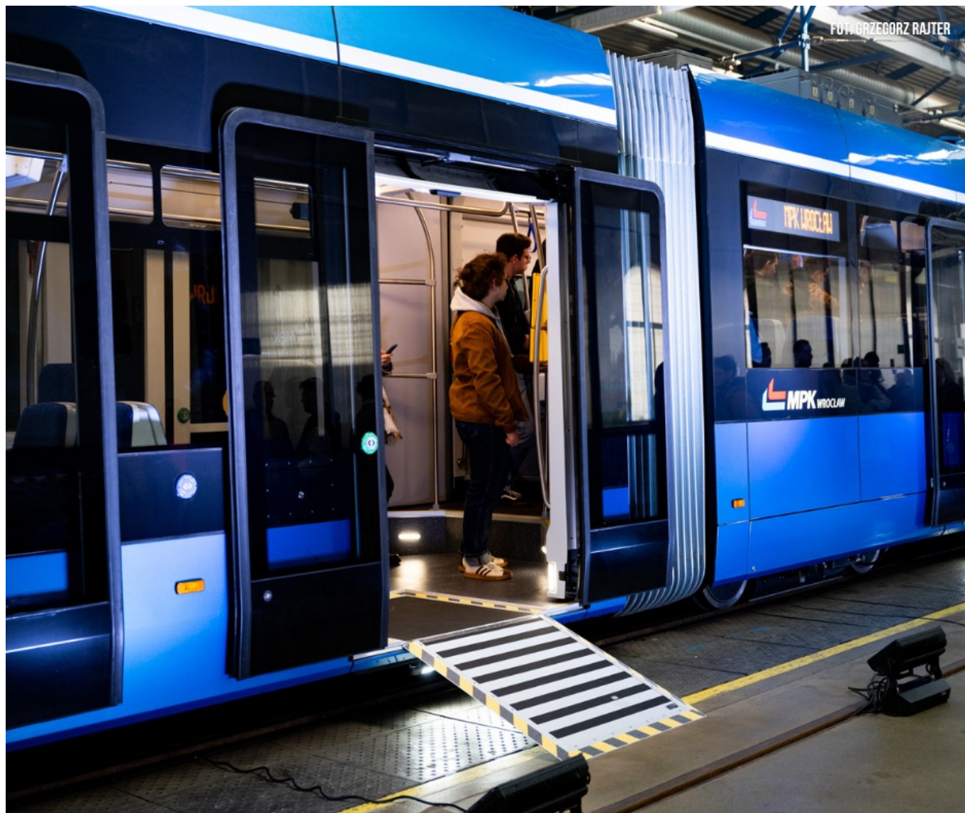
Elektrické plošiny pro vozíčkáře nahradily ručně výklopné. (zdroj: MPK Wrocław; foto: Grzegort Rajter)
