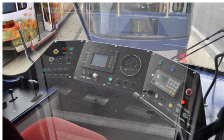
Stanoviště řidiče vozu T3MOD ev. č. 7304. Foto: Jakub Hluško
