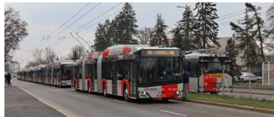
Odstavené trolejbusy Škoda-Solaris 24m na ulici K Letišti, odkud postupně vyjízděly dne 6. 3. 2024 na linku číslo 59. K nabíjení využívaly stopu posilovacího vedení, které není v běžném provozu určeno pro pojiždění. Foto: Vojtěch Povolný
