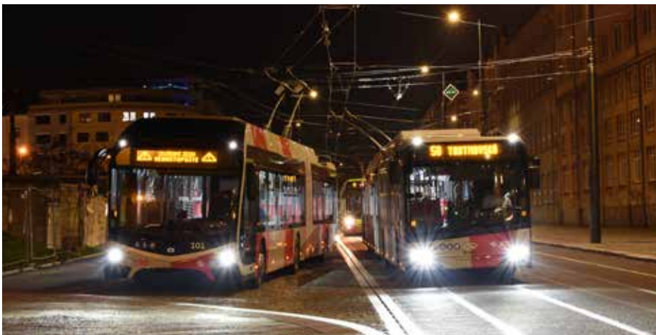
Setkání trolejbusů SOR TNS 18 ev. č. 101 s elektrickou výzbrojí od společnosti Cegelec a vozu Škoda-Solaris 24m s elektrickou výzbrojí od Škody Electric na Palmovce v prosinci 2023. Zatímco vůz ev. č. 401 obsluhoval linku č. 58, trolejbus ev. č. 101 se vydal na testování sběračů, které se ukázaly být Achillovou patou nových vozidel. Foto: Libor Hinčica
