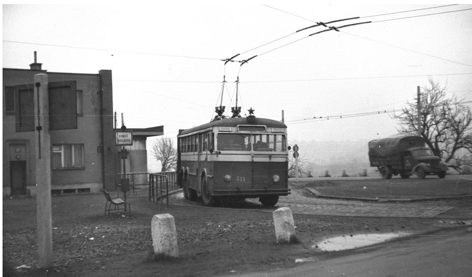
Na trati linky č. 59 se neobjevovaly jen trolejbusy Tatra 400, jak dokazuje tento snímek s vozem Praga TOT z koncové smyčky. Vůz ev. č. 311 byl vyroben v roce 1938. Celkem měla Praha 12 trolejbusů Praga TOT (včetně prototypu), z nichž poslední dojezdily v roce 1959. Prototyp se podařilo zachránit a je dnes ozdobou muzea pražské MHD. Sběrka: archiv DPP
