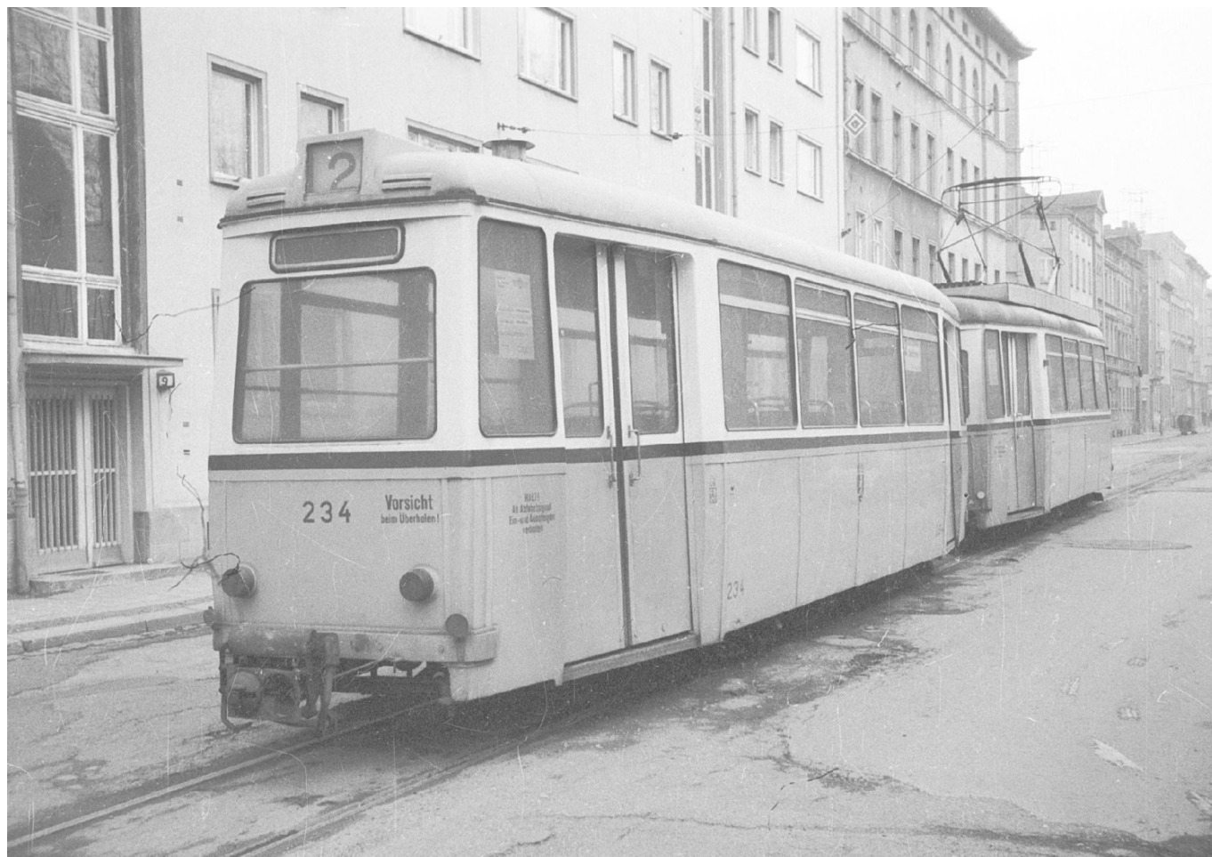
Vlečný vůz EB 54 původem z dráhy Klingenthal – Sachsenberg – Georgenthal během působení v Geře. Tramvaj zde sloužila cestujícím v letech 1972 až 1990. Od roku 1973 byla přestavěna na jednosměrnou. (sbírka: Frank Gecks)
