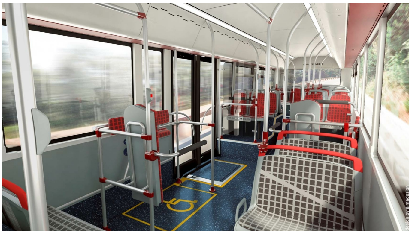
Pohled do interiéru vodíkového autobusu CaetanoBus (Toyota) H2.City Gold, zde v provedení pro španělského zákazníka. (foto: CaetanoBus)
