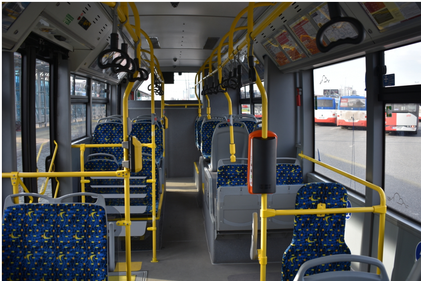
Pohled do interiéru trolejbusu Škoda 36 Tr s namontovaným odbavovacím systémem pražského DP. (foto: Libor Hinčica)
