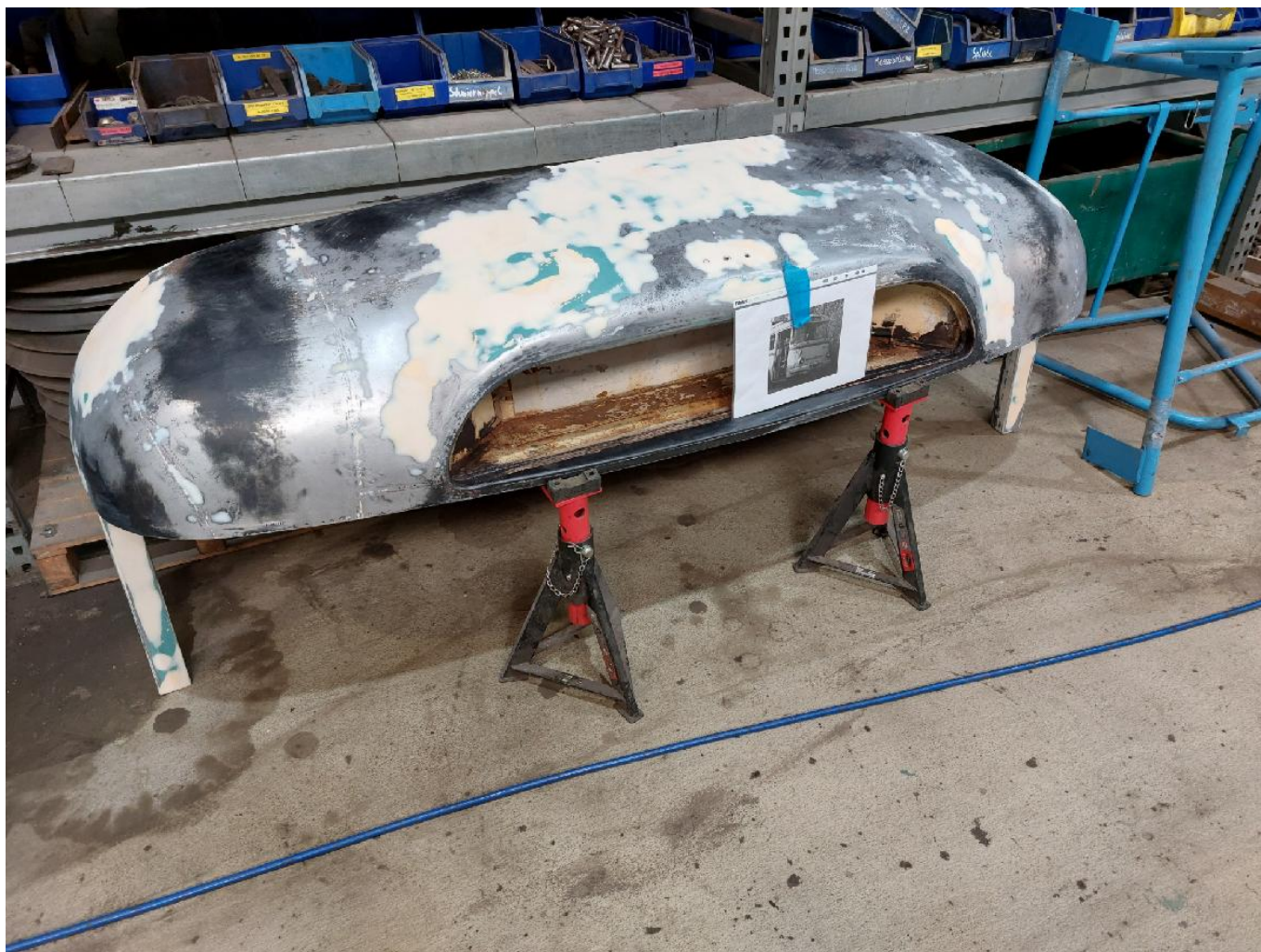
Oprava dochovaného střešního dílu. (foto: Ivo Köhler)
