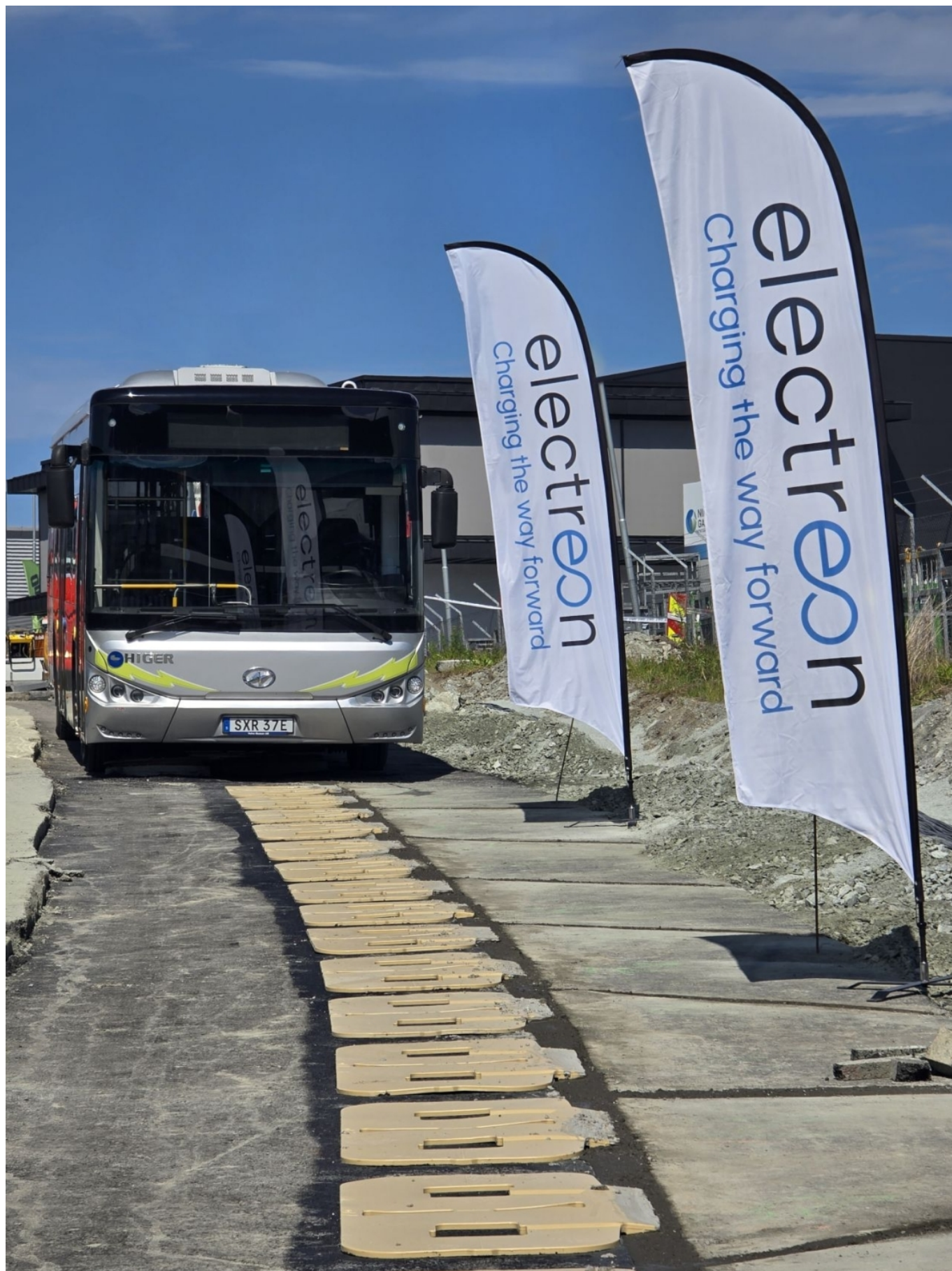
Zkušební jízda elektrobusu Higer se superkondenzátory nad ještě nezakrytou vozovkou s panely s cívkami v červenci 2024. (foto: Electreon)
