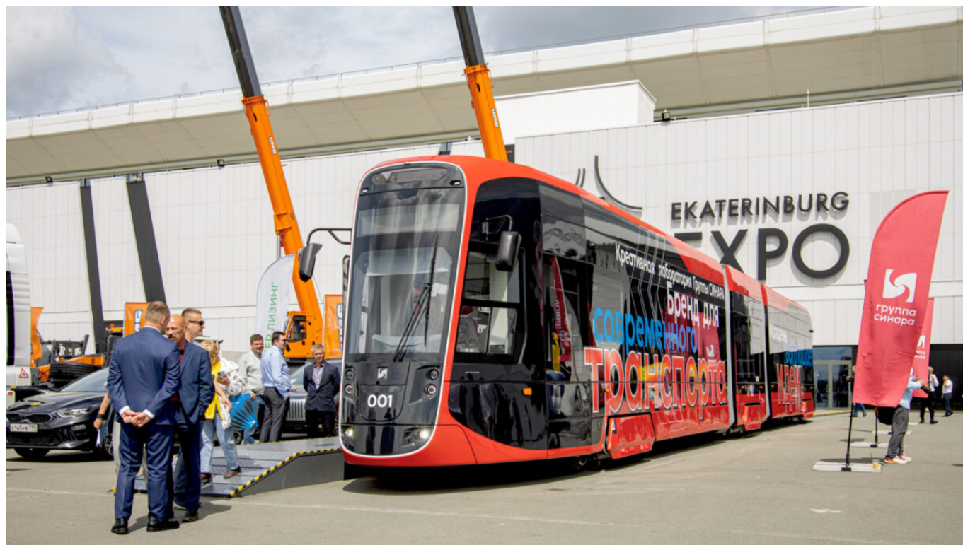
Tramvaj typu 71-233 od Sinary. Dle výrobce je jednoduše adaptovatelná na rozchod 1 435 mm. (foto: Ivan Revenkov)
