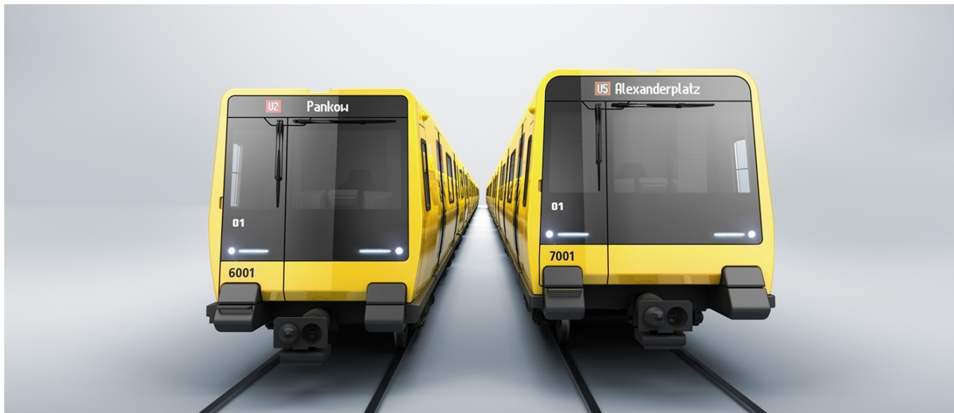
Porovnání maloprofilového (JK) a velkoprofilového (J) metra na vizualizaci Stadleru. (foto: Stadler)
