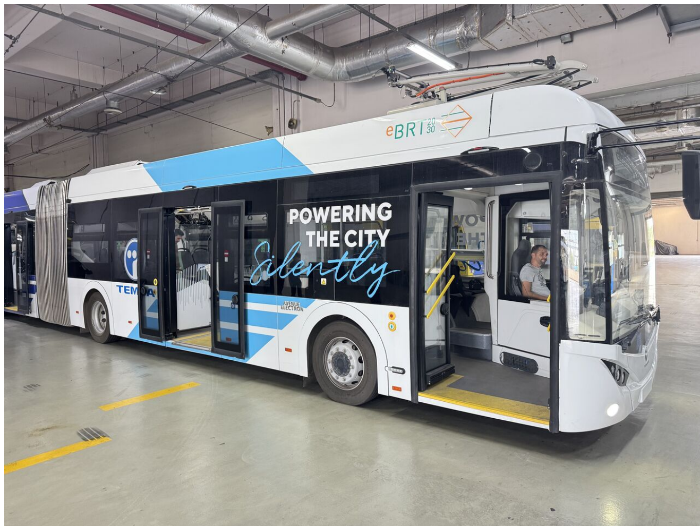
Elektrobuus TEMSA Avenue Electron o délce 18 m během testů nabíjení na podzim 2025 v athénské trolejbusové vozovně. (foto: Evaggelos Karvounis)
