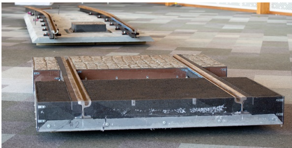
Celá konstrukce prefabrikátu s kolejemi má mít výšku jen 300 mm. Na zakrytí lze použít řadu různých materiálů, od těch klasických (žula, asfalt), až po recyklovanou gumu.(zdroj: Coventry City Council)
