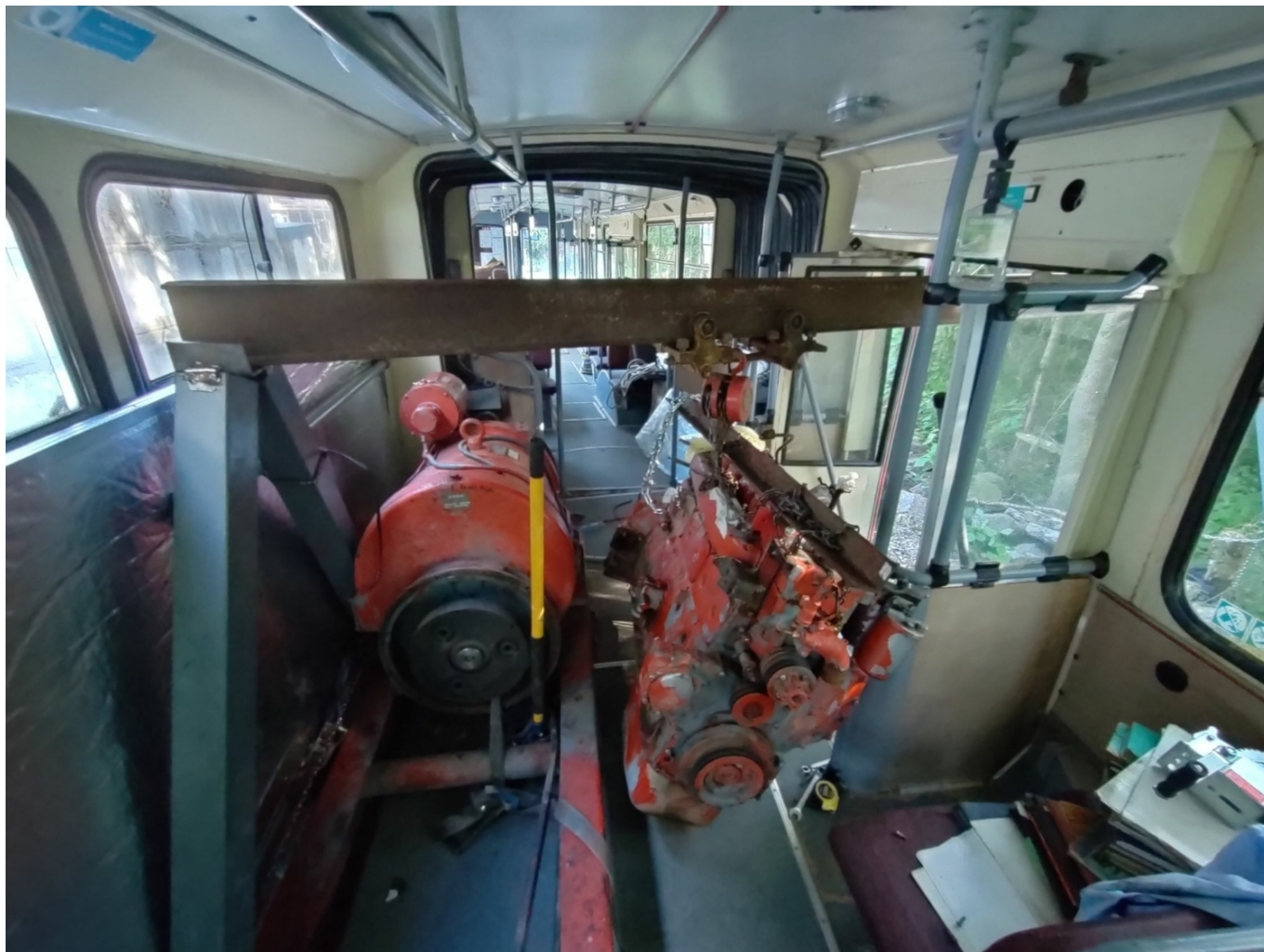
Celé zařízení se nasoukalo do trolejbusu skrze třetí dveře za využití provizorních jeřábových drah. (foto: Nigol Sobolev)
