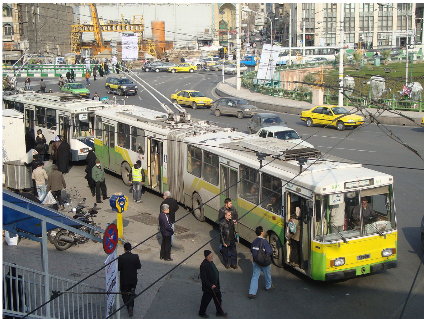
Trolejbus Škoda 15 Tr v Teheránu. Celkem dodala Škoda Ostrov do metropole Íránu 65 trolejbusů s bateriovým náhradním zdrojem pohonu. (zdroj: Wikipedia.org; foto: Mondephile)
