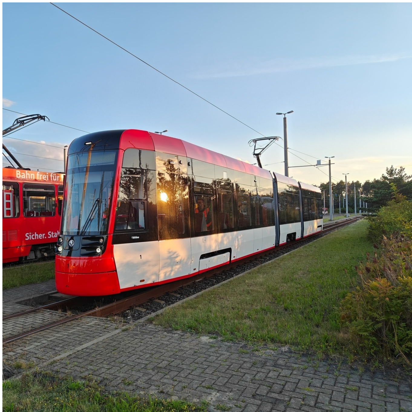
Tramvaje Škoda 47T v Cottbusu jsou oproti sourozencům ve Frankfurtu a Brandenburgu o 100 mm širší. (foto: Cottbusverkehr GmbH)
