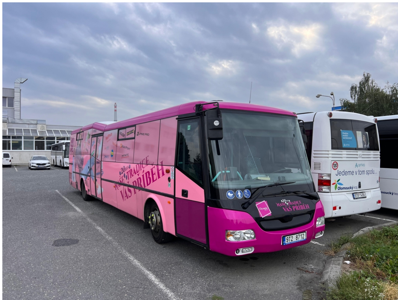
Autobus SOR (I)CN 12 s vypouklým nárazníkem, kterým se podařilo nahnat chybějící centimetry pro překročení mety 12,0 m. (foto: Martin Šmíd)
