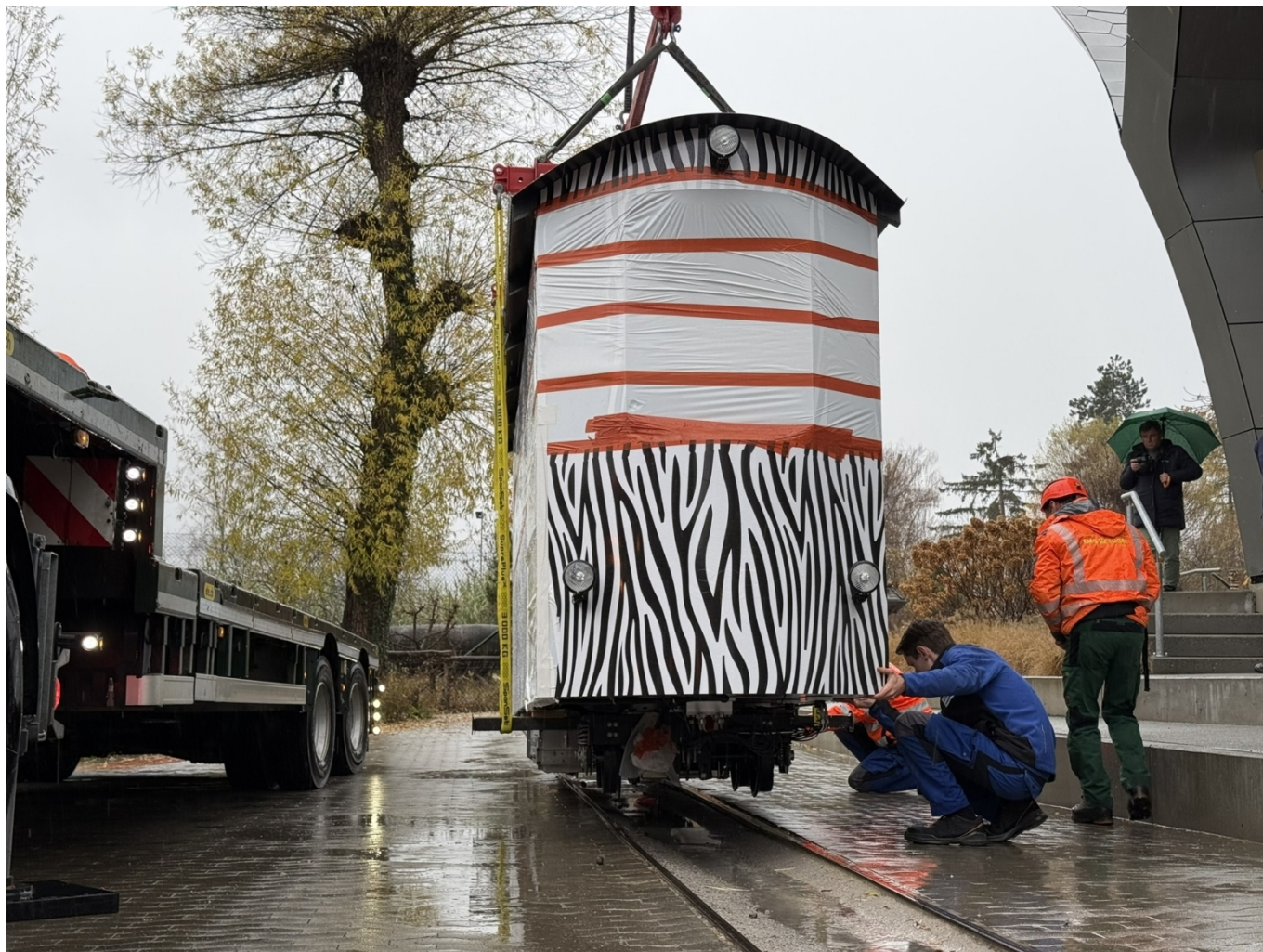
Usazení bateriové „tramvaje“ na koleje v areálu zoologické zahrady. (foto: Stadler)
