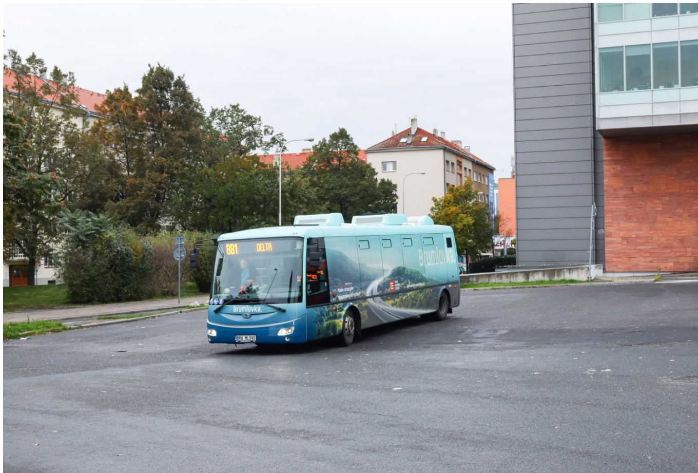
Elektrobus SOR EBN 9,5. V roce 2024 měl SOR výrobní řadu EBN inovovat použitím nových baterií s větším dojezdem. (foto: Vojtěch Povolný)
