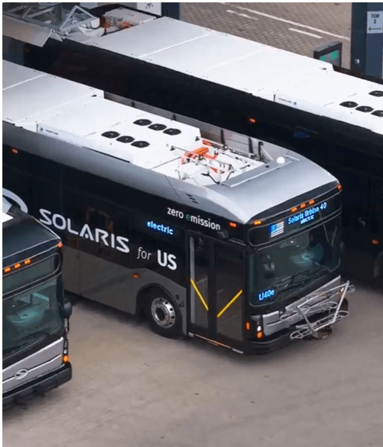
Pohled na uspořádání komponentů na střeše vozidel. (zdroj: Solaris Bus & Coach)
