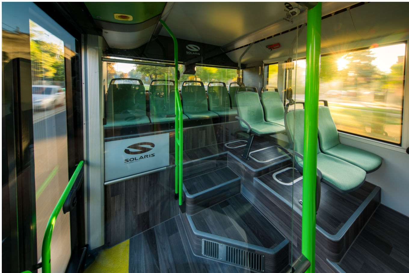
Provedení zadní části vozu bez „motorové věže“. (foto: Solaris Bus & Coach)
