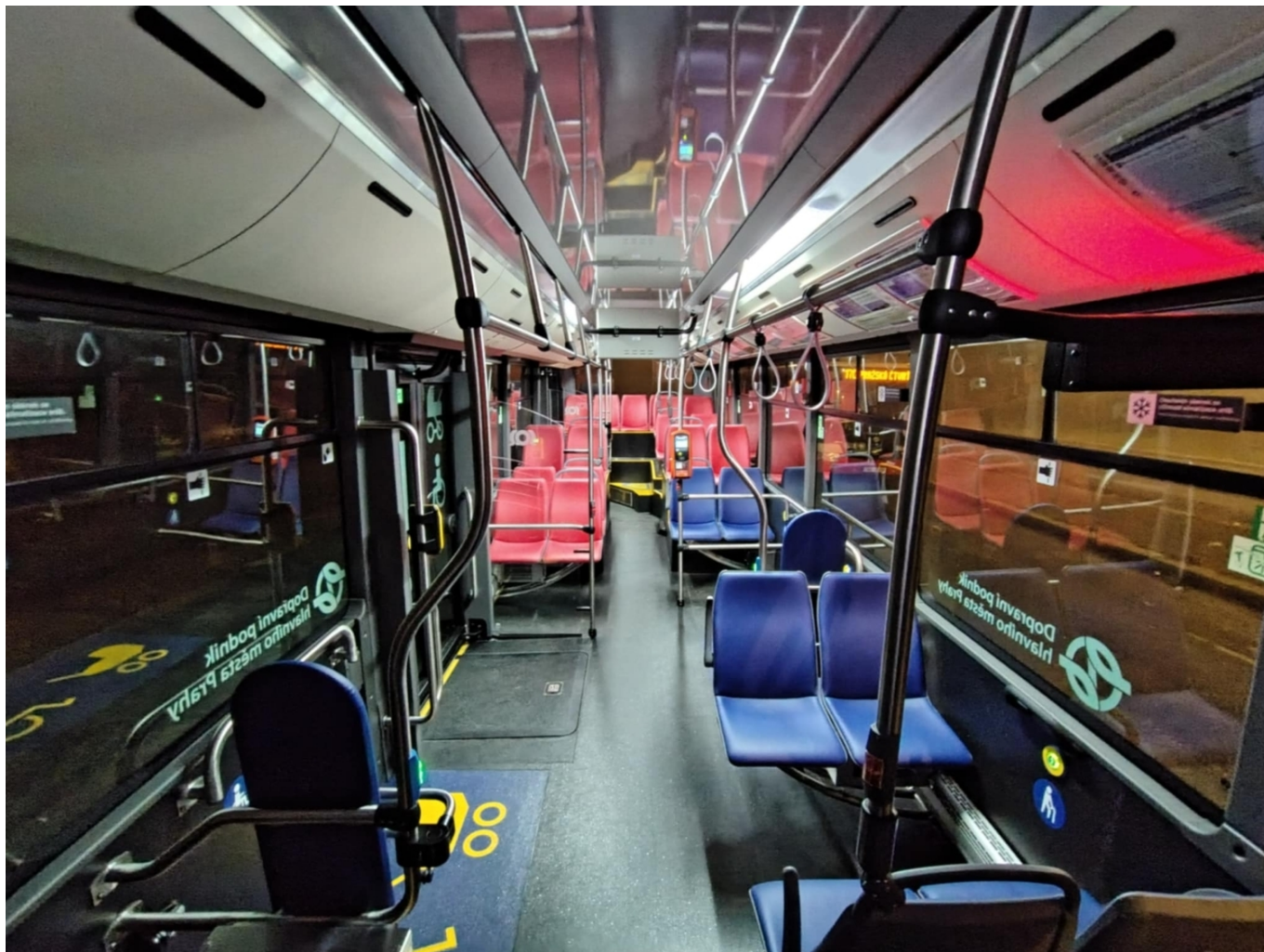
Vzdušný salon vozu s chybějící skleněnou přepážkou u 2. dveří, která mohla zmizet díky použití předsvuných dveří. (foto: Matěj Stach)
