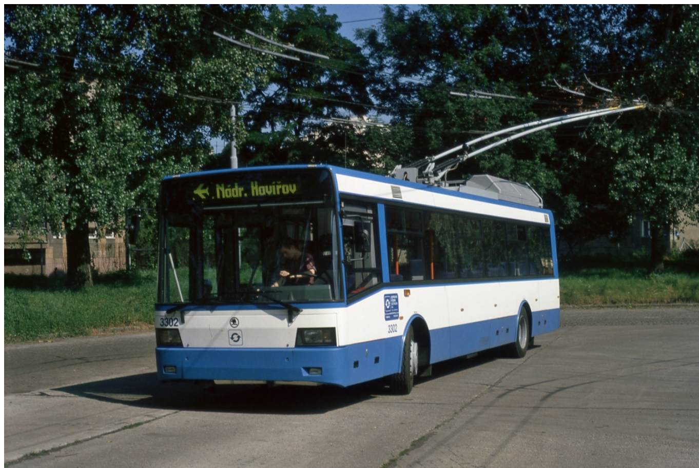
Trolejbus Škoda 21 Tr ev. č. 3302 v původním provedení na nádvoří trolejbusové vozovny. (foto: Ing. Petr Mitáček)
