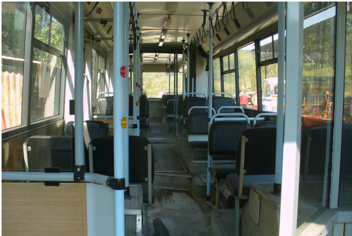
Pohled do interiéru I. prototypu vozu Škoda 22 Tr. N a snímku je dobře patrný schod v salónu. (foto: Ing. Vojtěch Kudláč)
