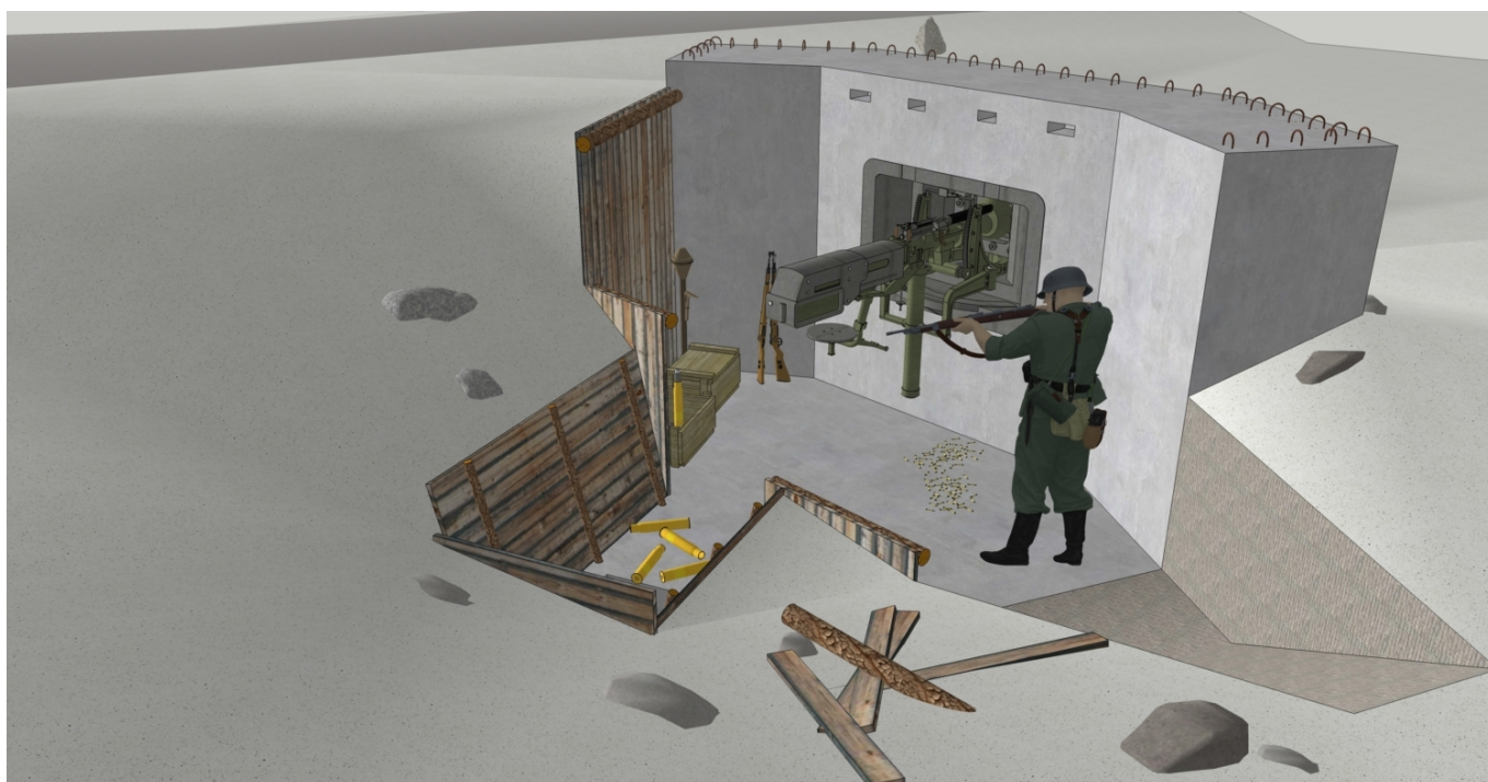
3D vizualizace betonového opevnění ve tvaru písmene U, jež se používalo prokazatelně v Bratislavě a v Olomouci. (zdroj: Ing. arch. Pavol Škorvánek; bunkre.info)
