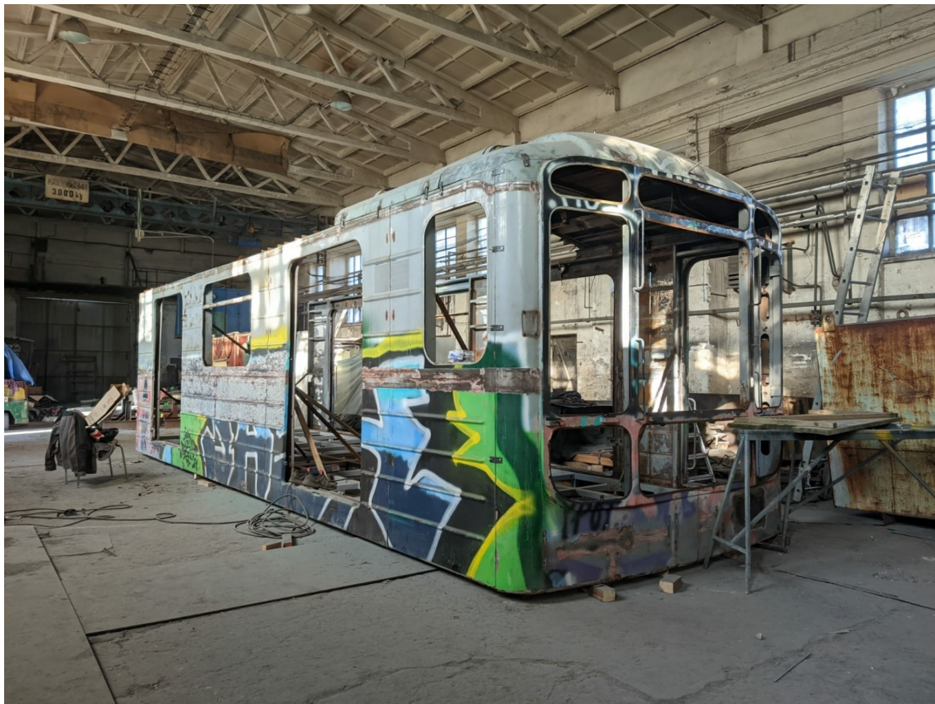
Skelet po rozříznutí a umístění na nově svařený podlahový rám. (foto: Kryštof Šenkýř)
