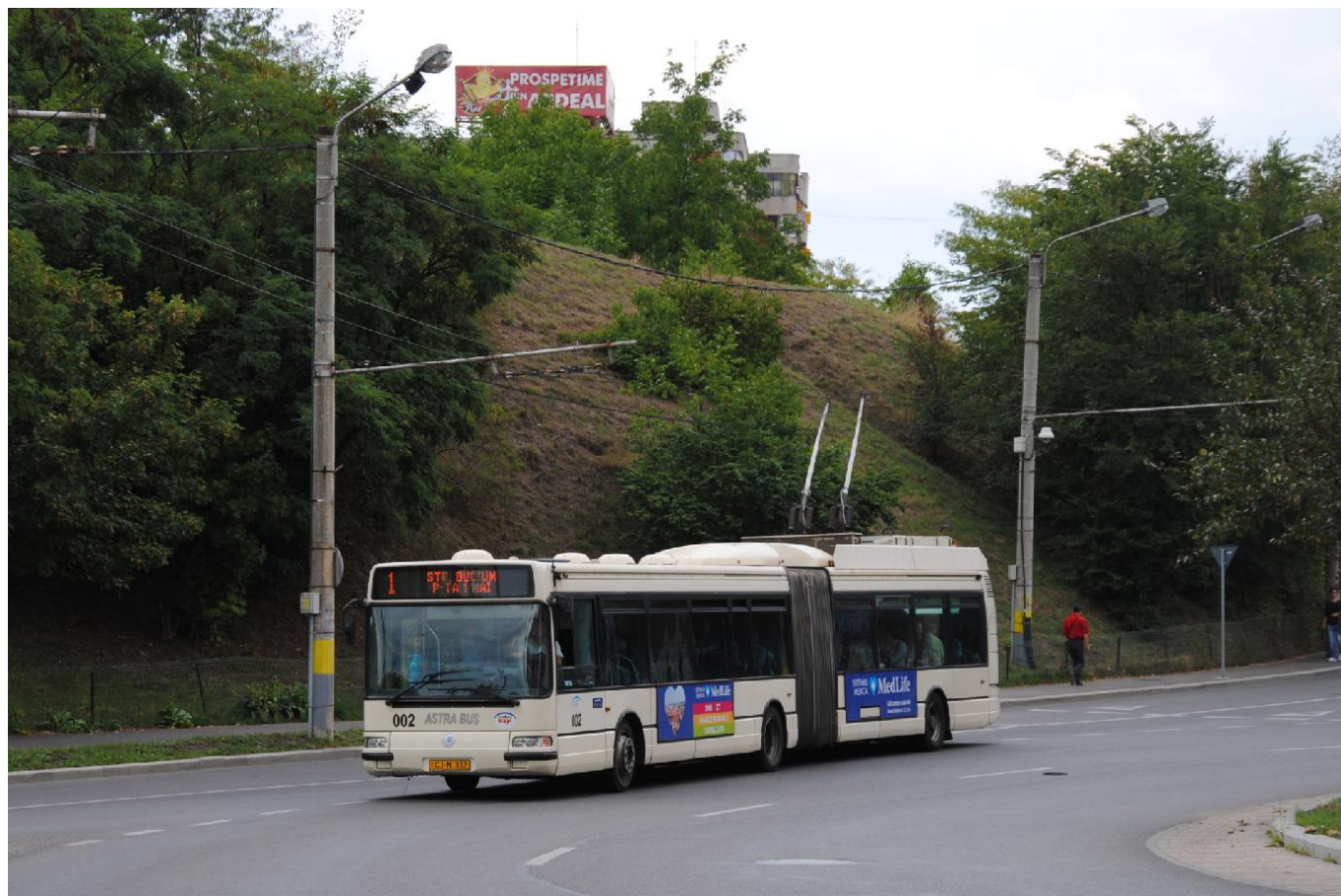
Trolejbusy přestavěné z ex-pařížských autobusů Agora L vznikly v letech 2011 a 2012. (foto: Lukáš Tuček)
