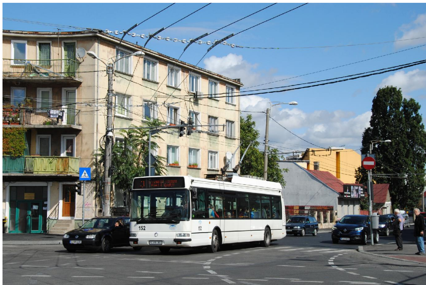
Trolejbusy přestavěné z ex-pařížských autobusů Agora L vznikly v letech 2011 a 2012. (foto: Lukáš Tuček)
