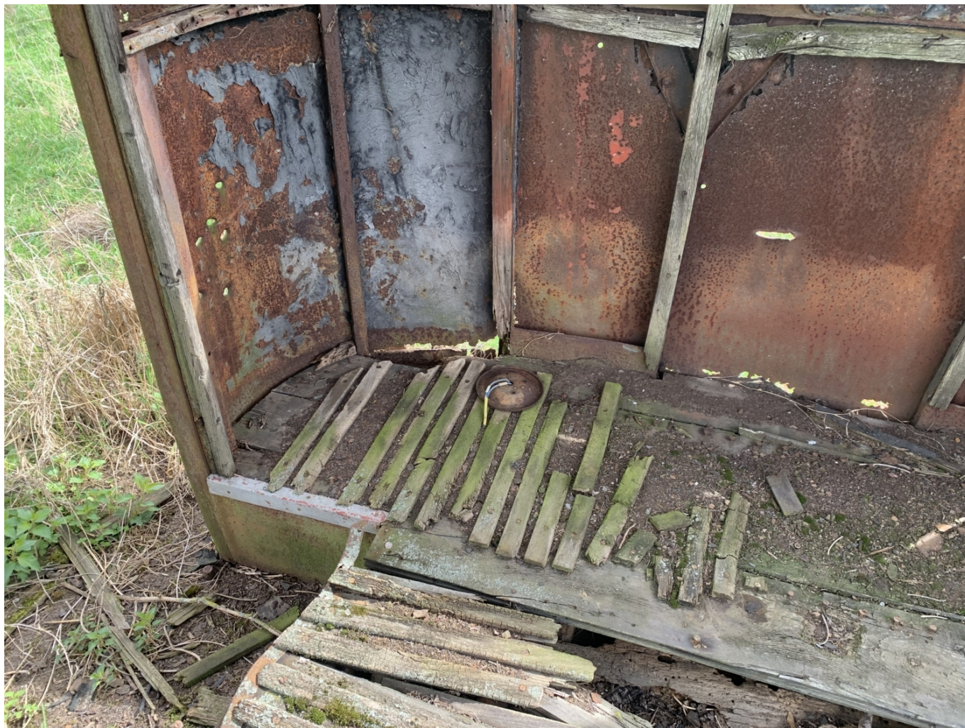
Ztrouchnivělé zbytky podlahy na zadní plošině. (foto: Libor Hinčica)
