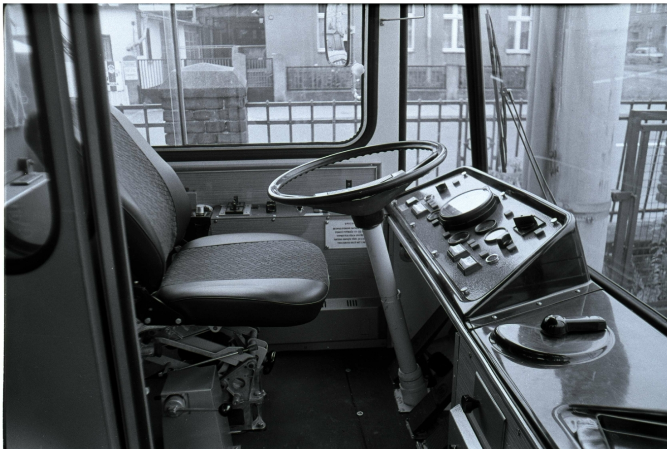
Stanoviště řidiče předváděcího trolejbusu 15 Tr, který dodnes slouží na Ukrajině. (foto: Mattis Schindler)
