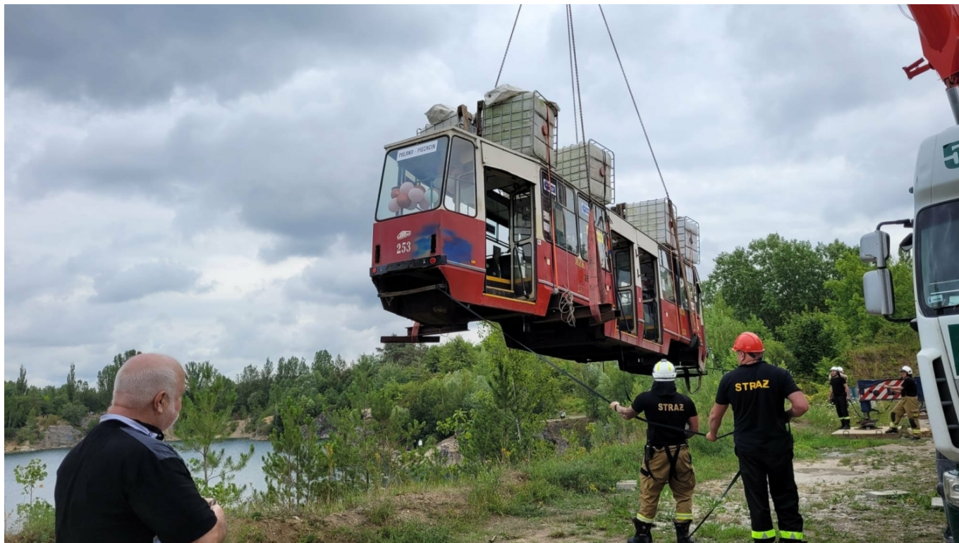
Zvedání tramvaje za pomoci silničního jeřábu. Na střeše jsou patrné balastní nádrže. (foto: MZK w Toruniu)
