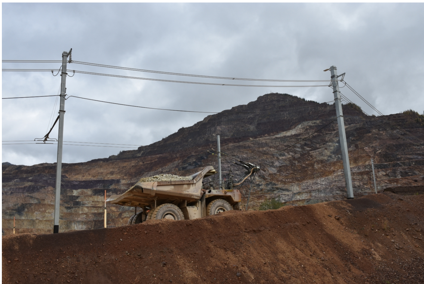
Pohled zezadu na stoupající nákladní vůz Liebherr T236 ukazuje provedení speciální konstrukce pro trolejbusové sběrače. (foto: Libor Hinčica)
