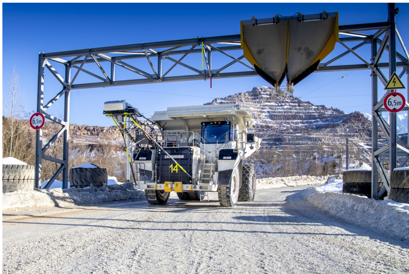
Nákladní vůz Liebherr T236 míjí při jízdě na diesel natrolejovací portál s typickým trychtýřem. (foto: August Zobl; VA Erzberg GmbH)
