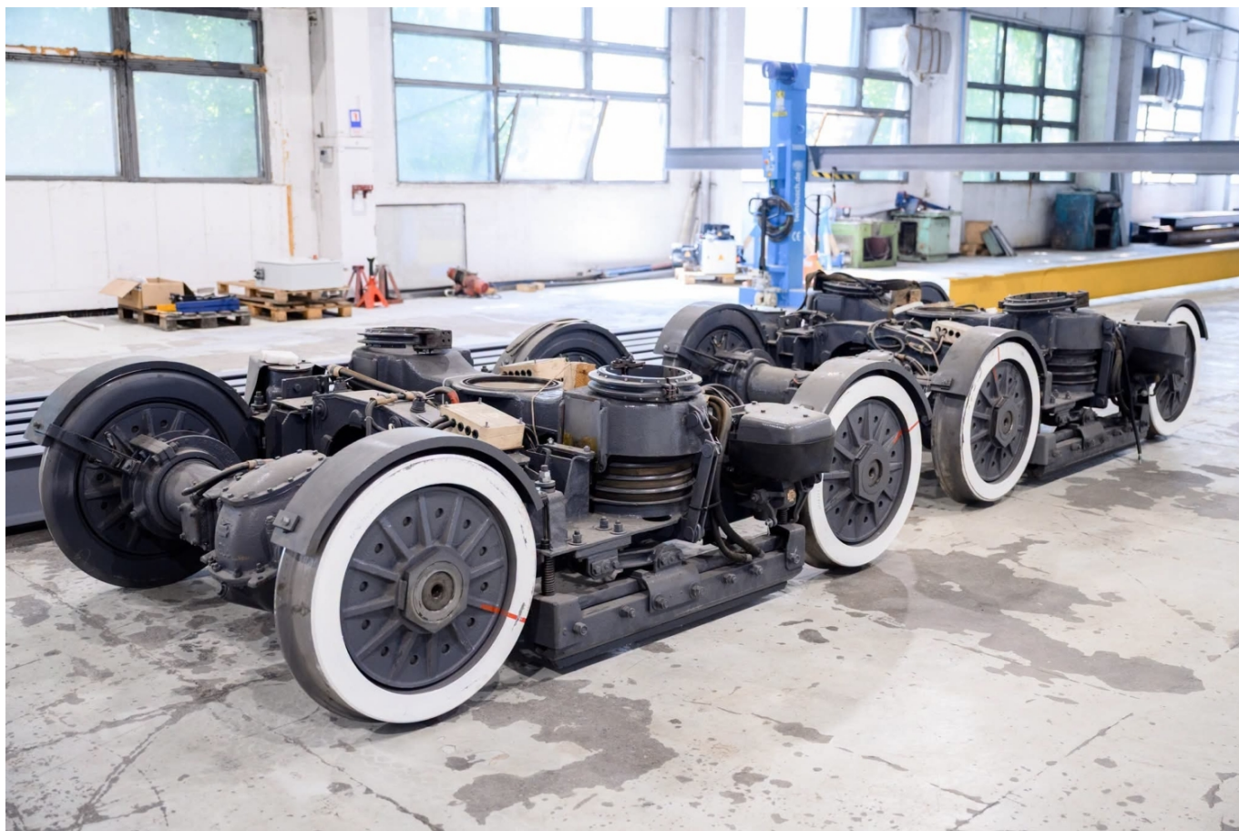
Pod vozem budou namontovány původní tatrovácké podvozky. (foto: InformBusiness)
