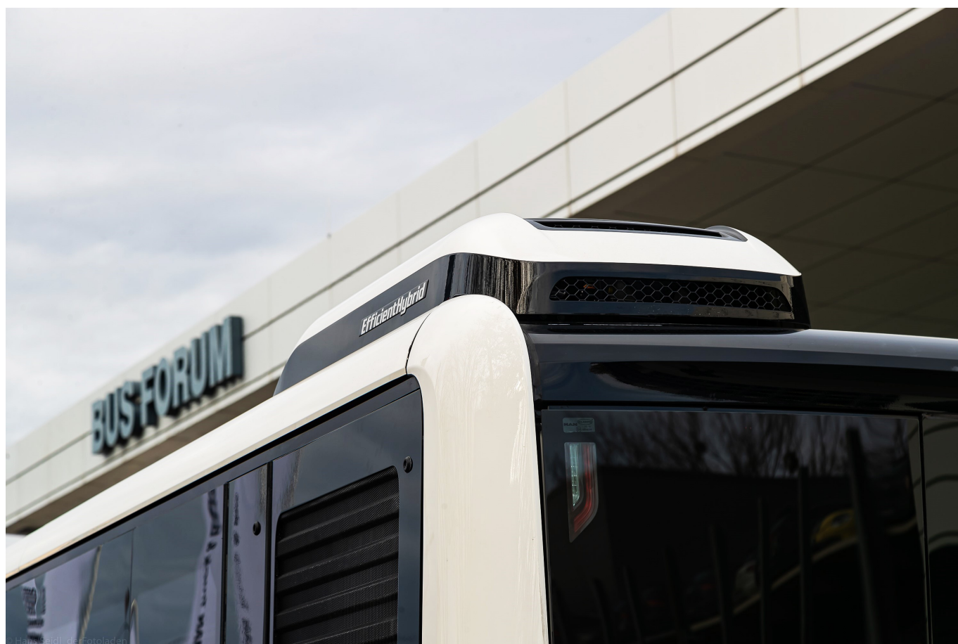
Detailní pohled na modul se superkondenzátory na střeše vozidla Lion's City. (foto: MAN Truck & Bus)
