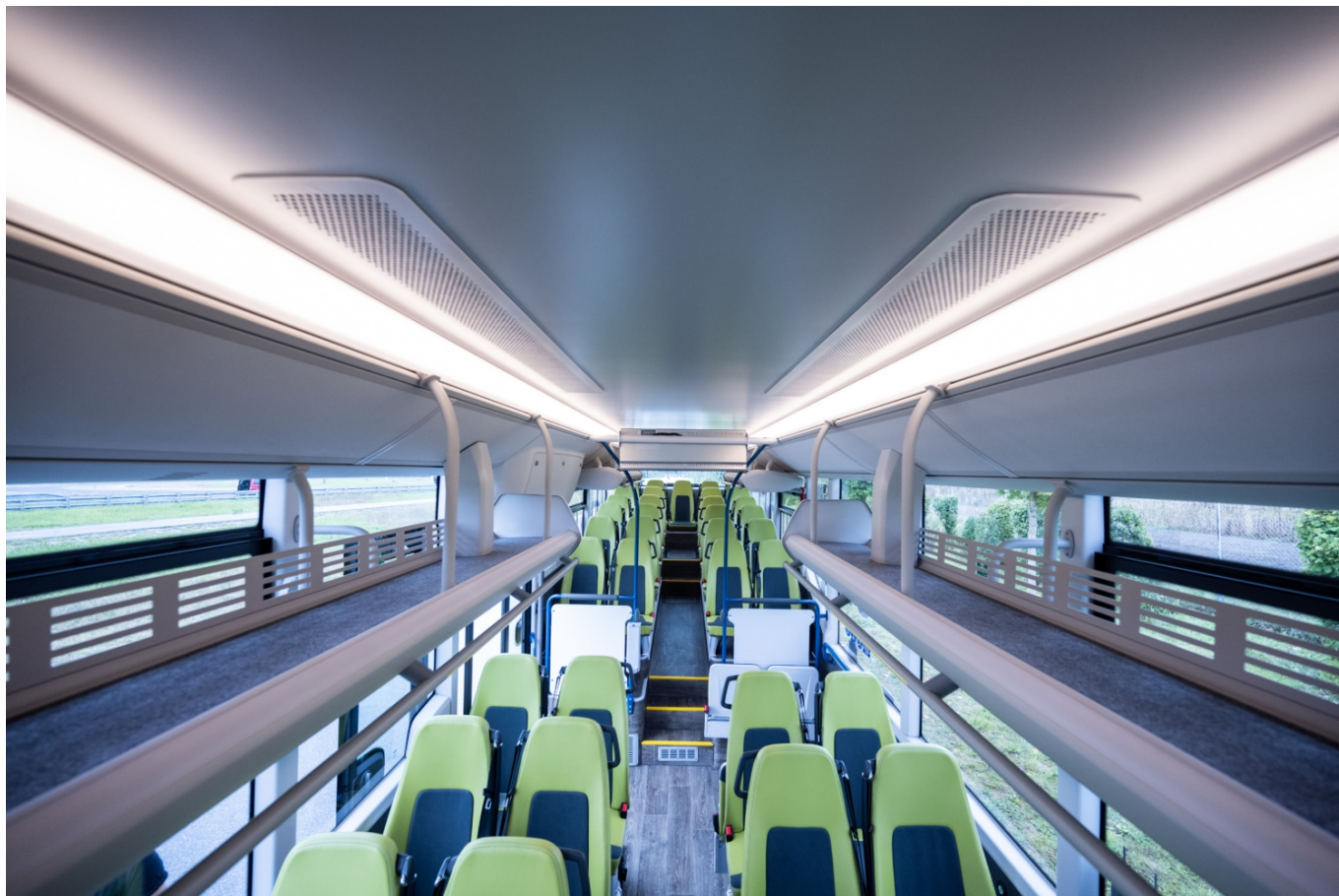
Detail provedení otevřených polic na zavazadla. (foto: MAN Truck & Bus)
