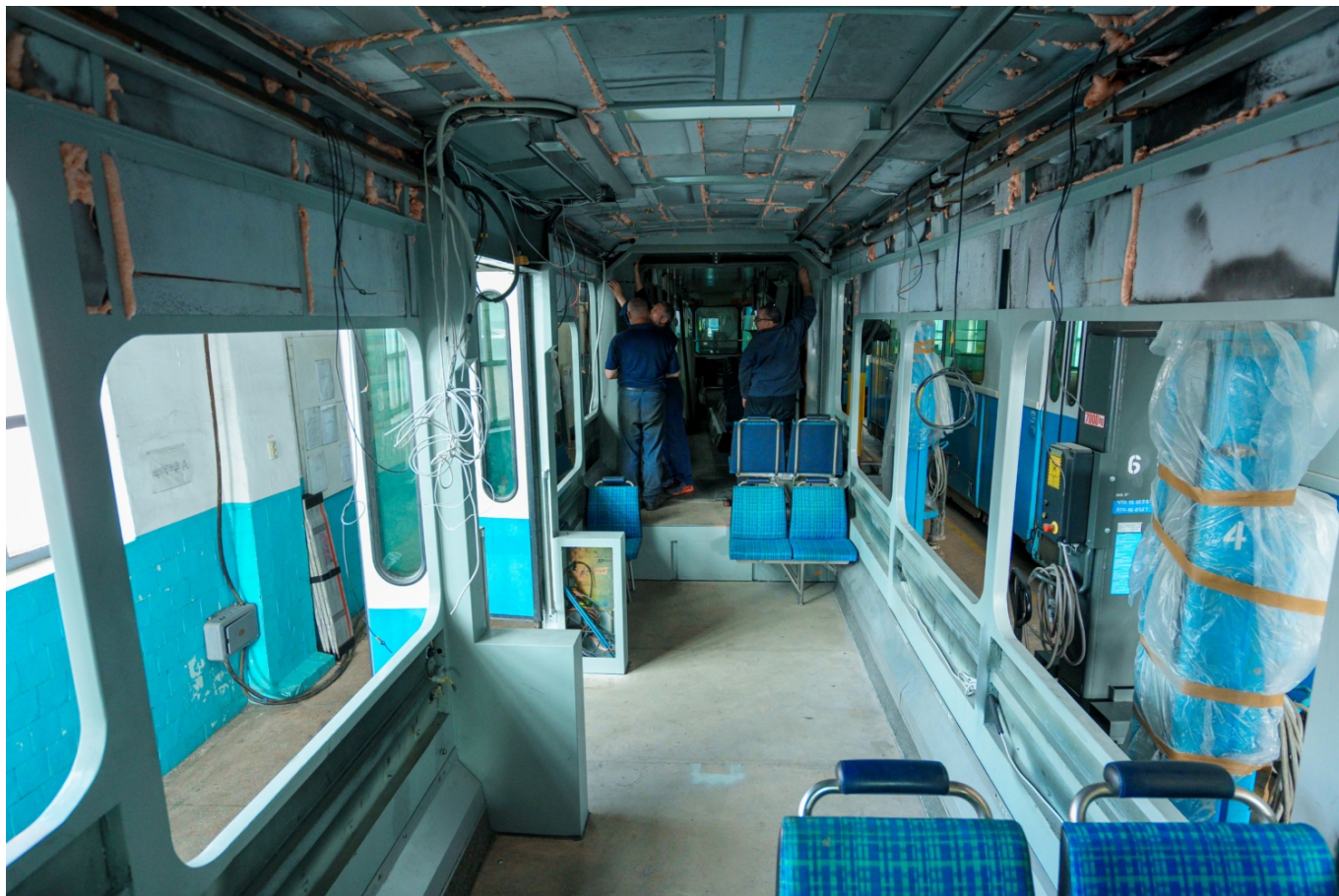
Pohled do nově vyrobeného středního článku během modernizace. (foto: město Vinnycja)
