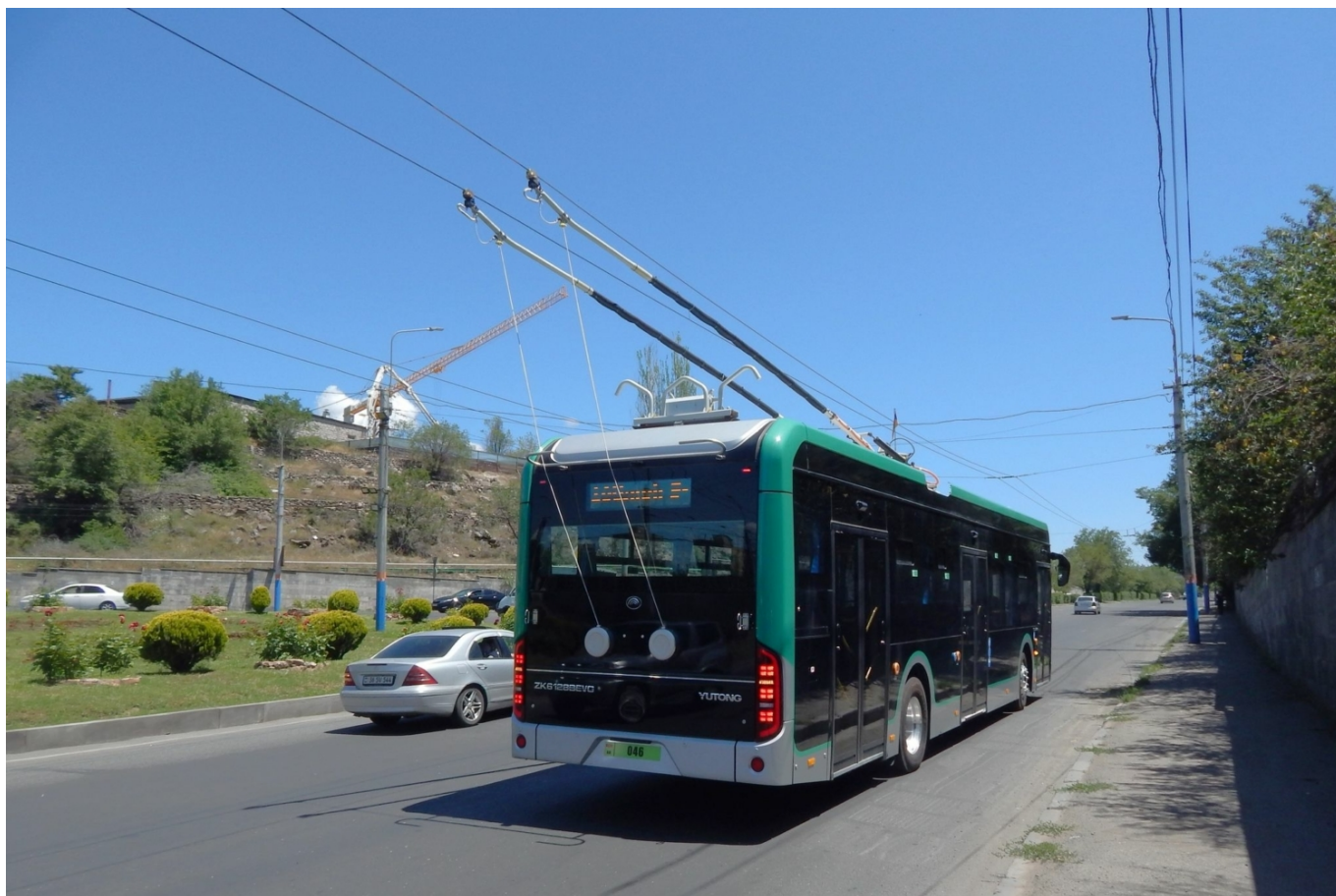
Pohled zezadu na parciální trolejbus Yutong ZK6128BEVG během zkušební jízdy v Jerevanu dne 2. 7. 2023. (foto: Artavazd Khachatryan)
