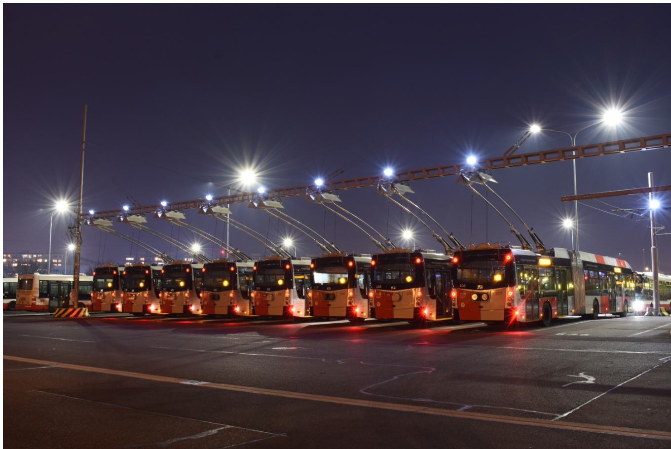
Část flotily pražských trolejbusů SOR TNS 18 s elektrickou výzbrojí Cegelec řady Alva během jedné z mnoha zkoušek sběračové soustavy polské společnosti EC Engineering v areálu garáží Klíčův na konci roku 2023. (foto: Libor Hinčica)
