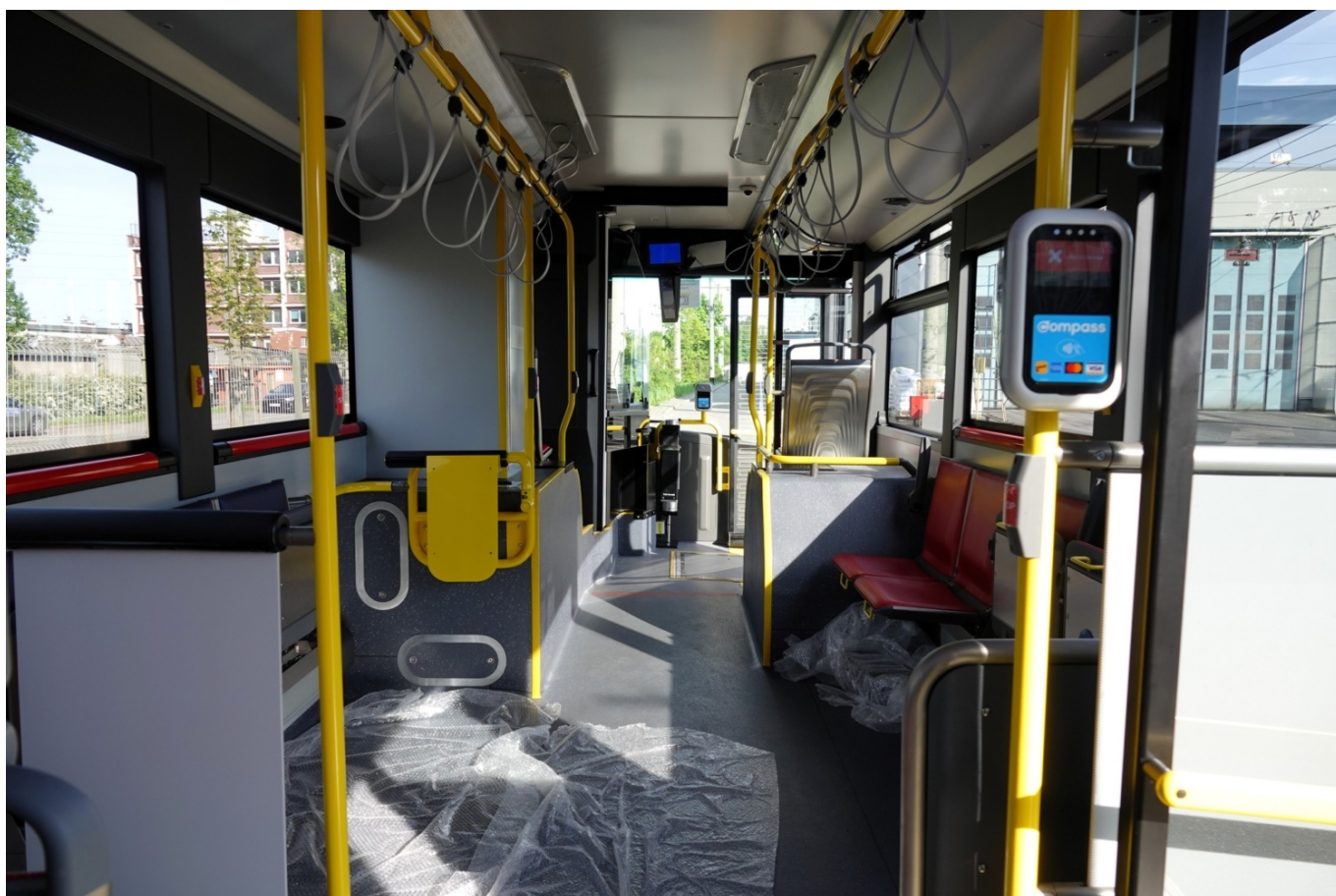
Přední část vozu se sklopnými sedačkami a „kabinetem“ pro veškeré řídicí systém vozidla. Vše je
