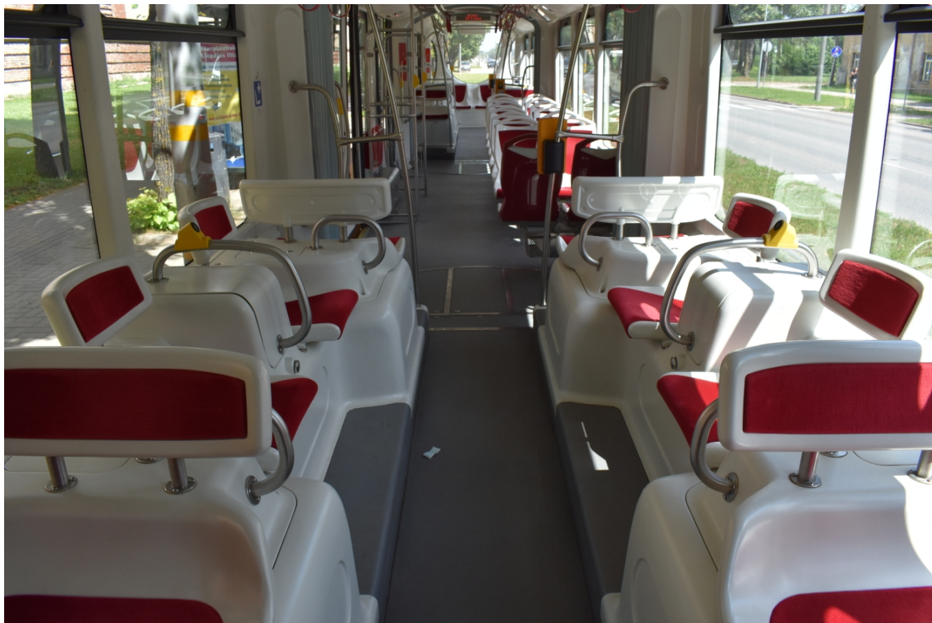
Pohled do interiéru vozu s netradičním uspořádáním sedadel nad podvozky. (foto: Libor Hinčica)
