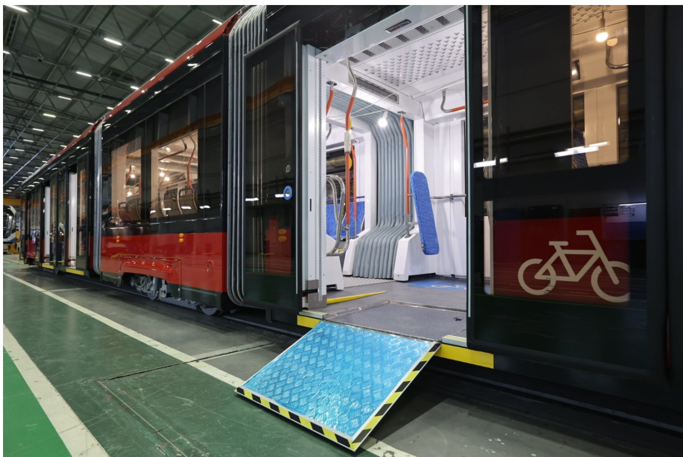
Nová tramvaj s výklopnou plošinou. (foto: 3x PK TS)
