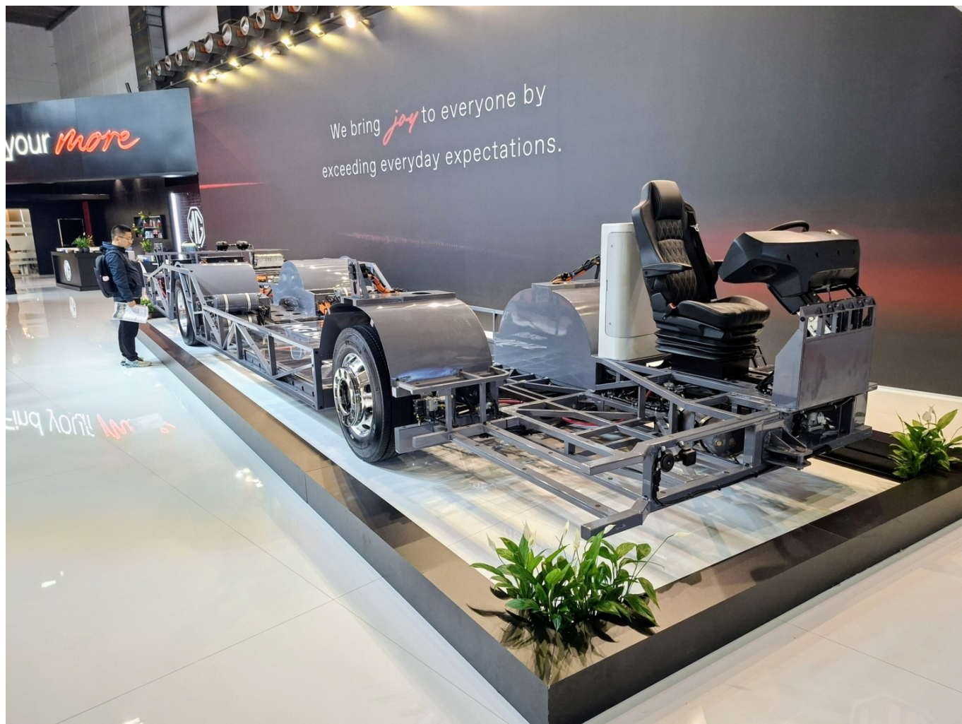
Autobusový podvozek B12E je možné si zakoupit i ze strany nástavbářů. (foto: Libor Hinčica)
