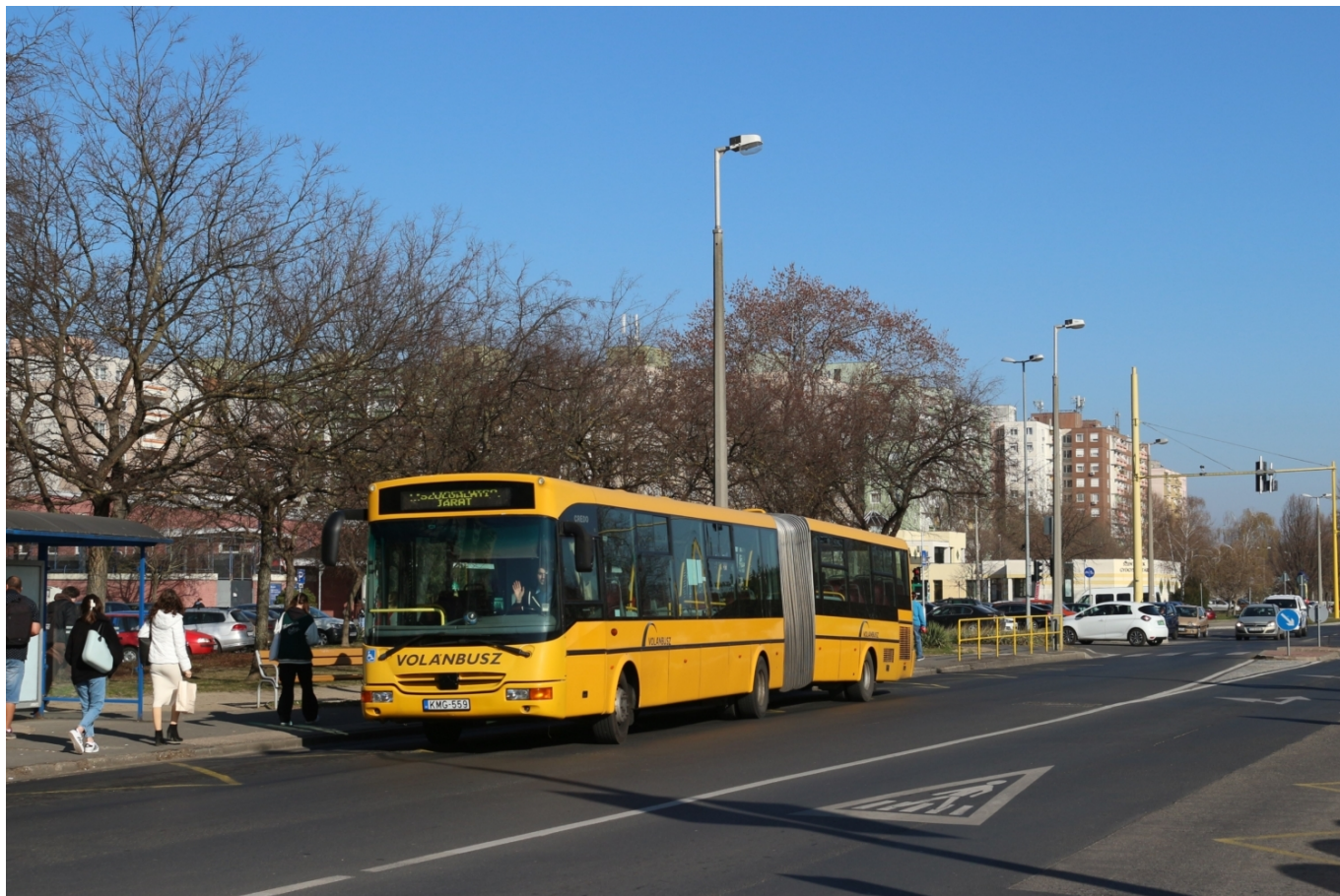
Autobus Credo BN 18 byl koncipován jako částečně nízkopodlažní vůz. Snímek představuje jeden z 36 vyrobených vozů v maďarském Győru. (foto: Dominik Konečný)
