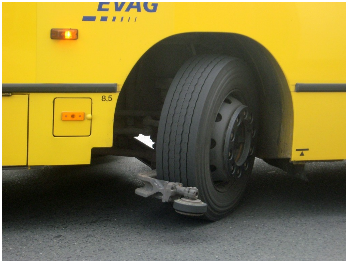
Detail vodícího kolečka. (zdroj. Wikipedia.de)
