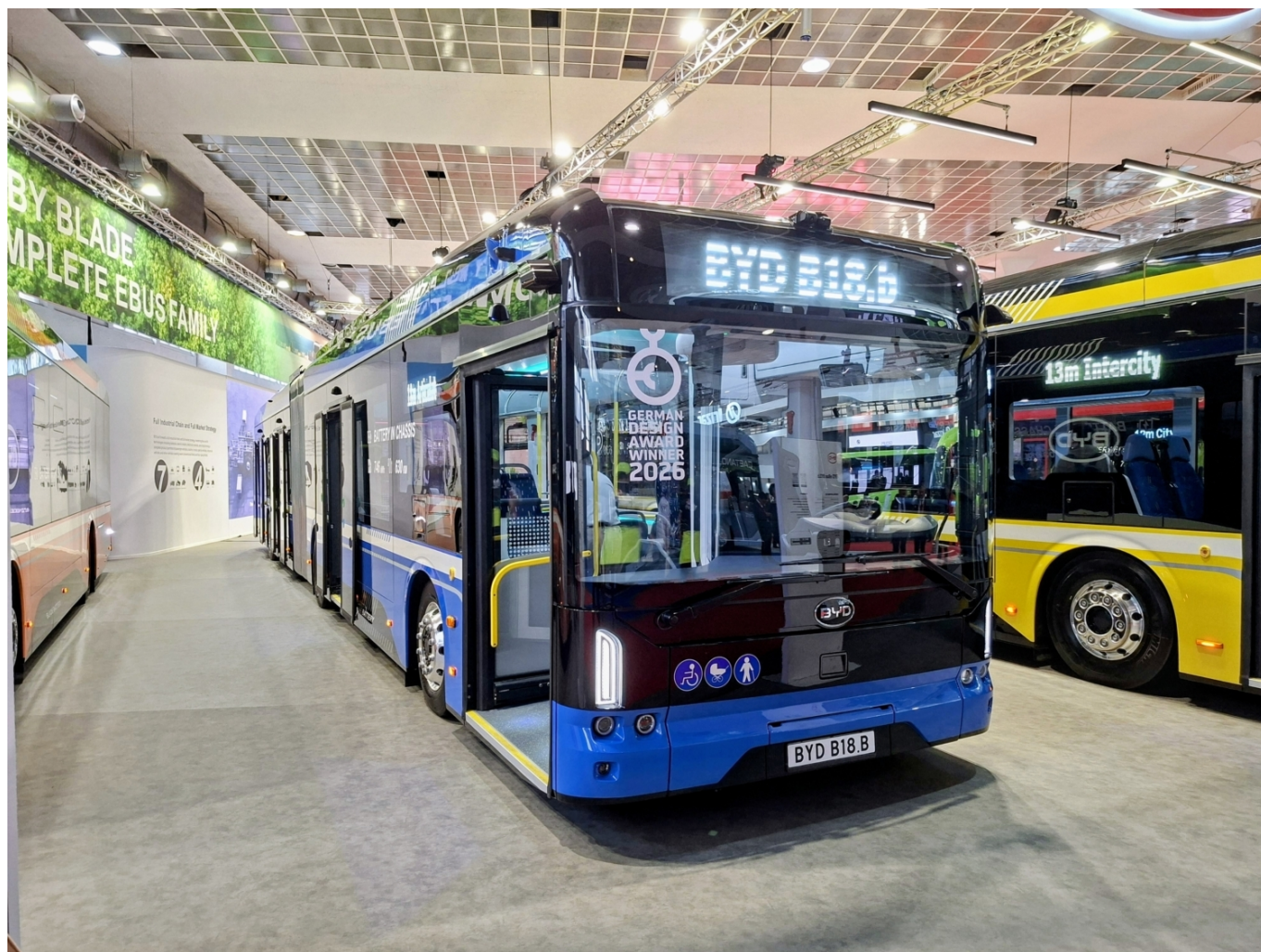
Elektrobus BYD B18.b na veletrhu Busworld v Belgii. Vůz nabízí teoretický dojezd až 630 km (v některých zdrojích uvádí výrobce dokonce 680 km). (foto: Libor Hinčica)
