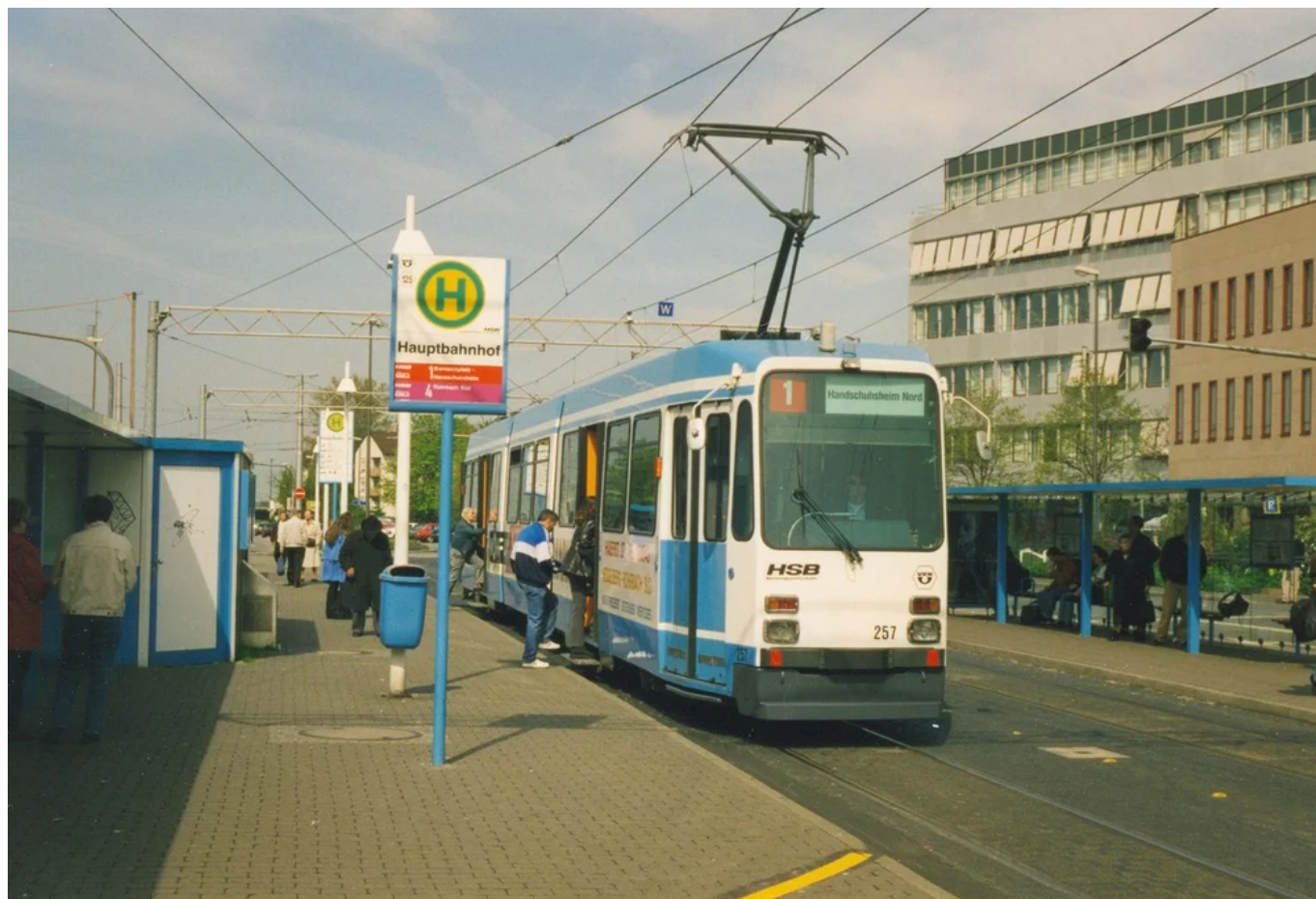
Původní provedení tramvají M8C v Heidelbergu před modernizací na snímku z roku 1998. (foto: Jürgen Niemeyer; RNV)
