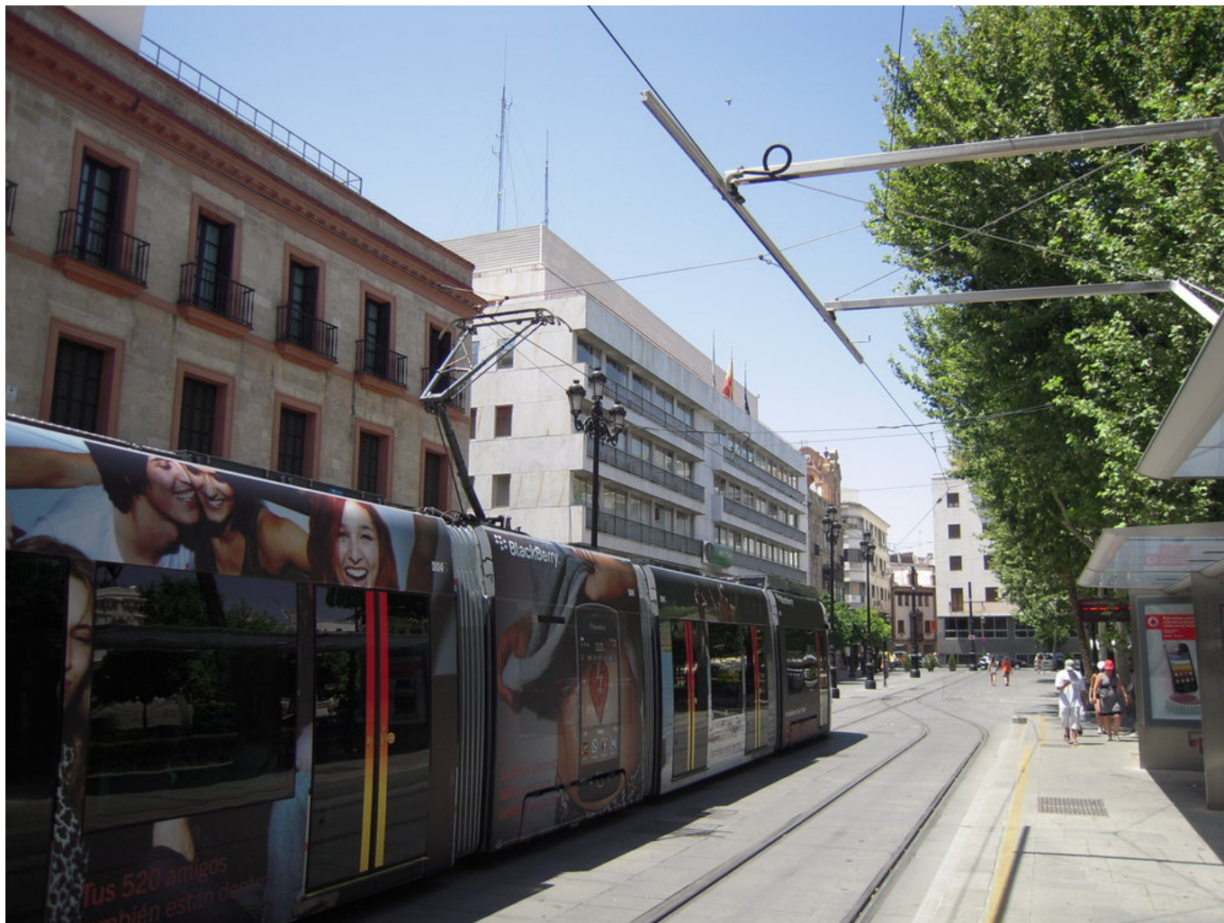
Nabíjecí rameno na konečné Plaza Nueva
